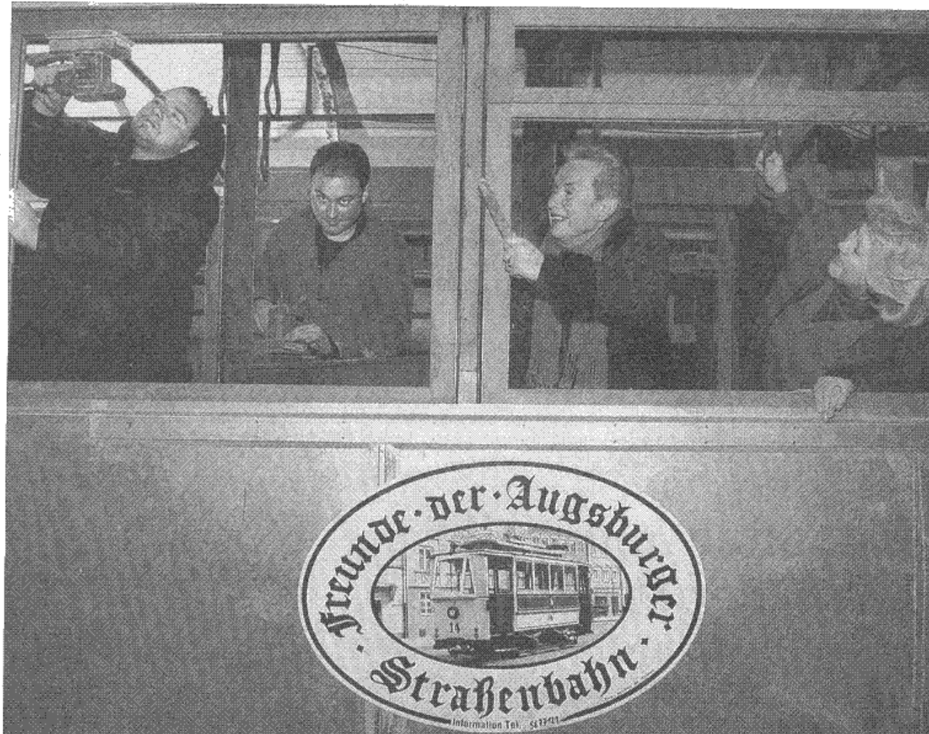
Munter ans Werk mit Schleifmaschine und Drahtbürste: Jürgen Centner, Michael Egger, Resi Uhl, Finni Egger (von links) entfernen alte Farbe vom Holzrahmen der alten Straßenbahn. AZ-Bilder: Silvio Wyszengrad
